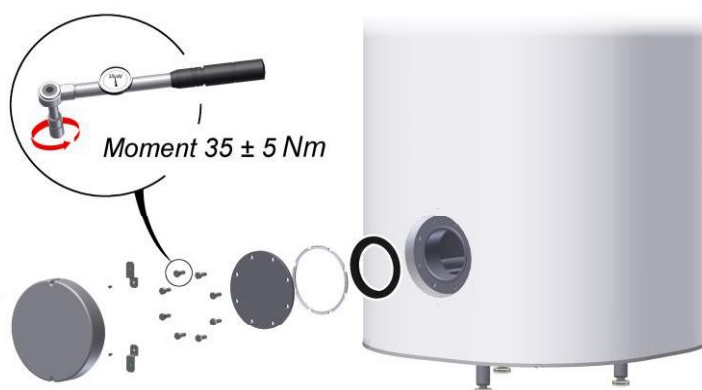
Rys. 11 Montaż pokrywy otworu rewizyjnego (kolejność montażowa)
