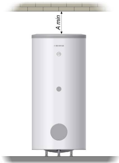
Rys. 4 Minimalna odległość do wymiany ochronnej anody magnezowej
